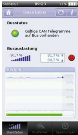
CANtouch-Messung mit hoher Bus-Last.
